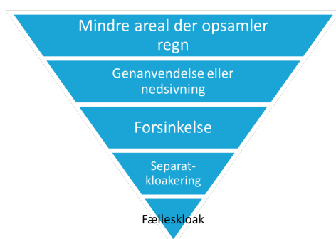
Figur 1.2 Den blå trekant der angiver prioriteret angivelse af rækkefølgen af virkemidler for eksisterende og nye kloakker.
