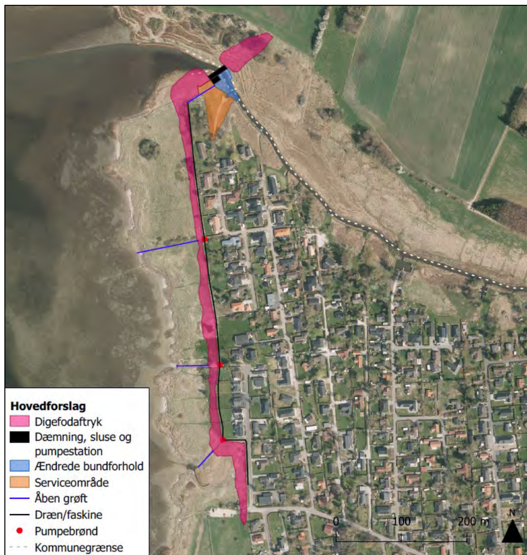
Figur 2-2 Principskitse af fjorddigets og fløjddigets udbredelse samt sluse og serviceområde.
