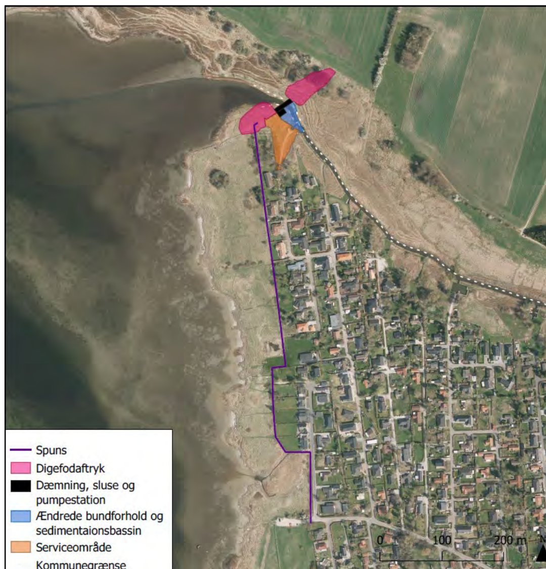
Figur 2-12 Alternativ 2: Etablering af fjorddige som spunsvæg.
