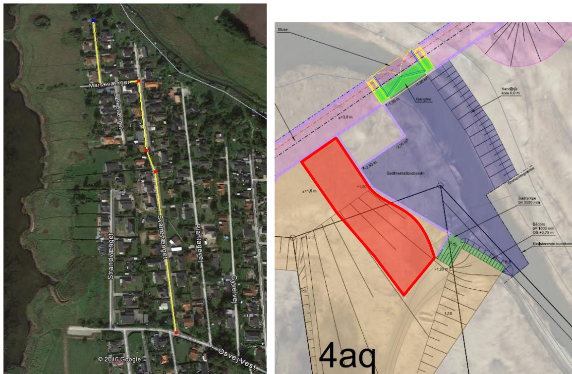
Figur 6-6: Adgangsvej via Svanevænget og Marskvænget (tv) og jordstabiliseret adgangsvej på området markeret med rød (th).
