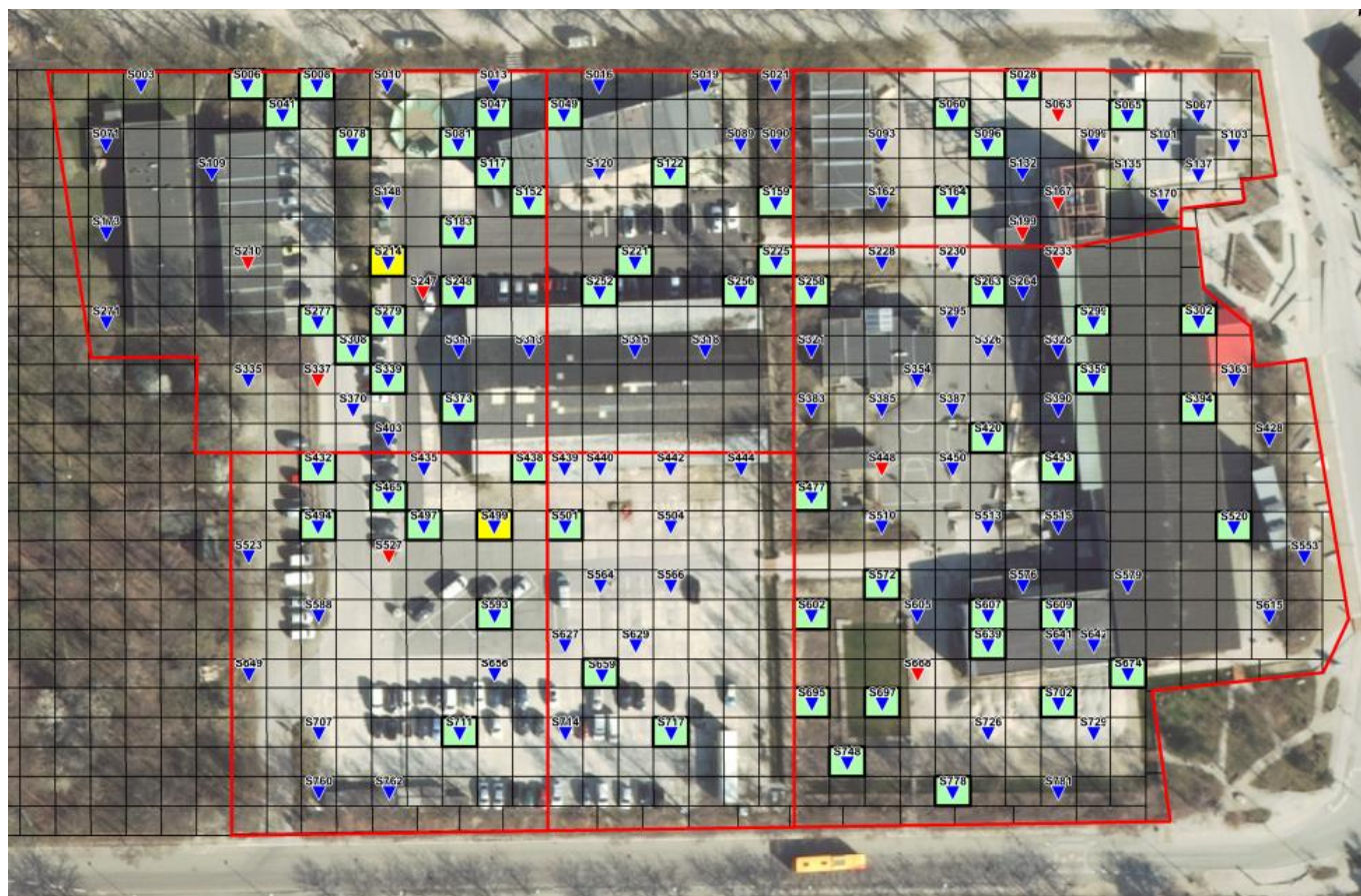
Figur 2-9 Placering af udførte poreluftmålinger (blå trekanten). Fund af totalkulbrinter/benzen over afdampningskriterierne (lys grøn) og fund af totalkulbrinter over 100x afdampningskriteriet (gul). De røde trekanten er punkter hvor det ikke har været muligt at gennemføre poreluftmålinger. Figuren viser et udsnit af bilag G.
