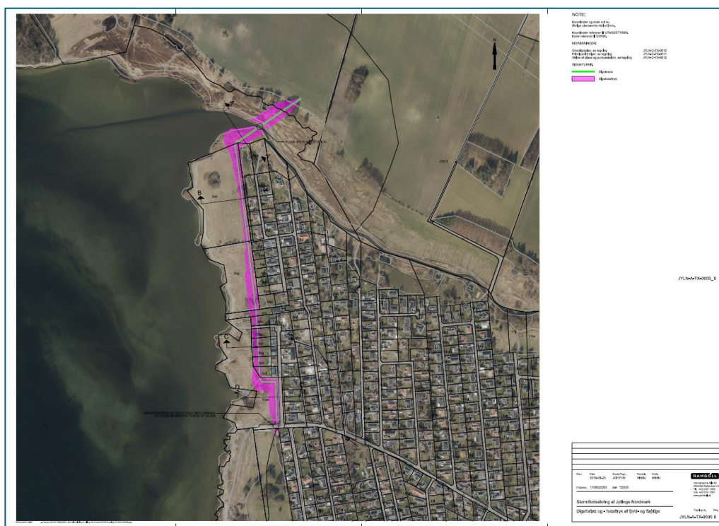
Figur 1 Kort over placering af fjorddige og fløjdige med sluse /25/. Ved anlæg justeres digets forløb, så digefoden følger vestskele på ejendommene 3dh, 3dg, 3df og 3de Jyllinge.
